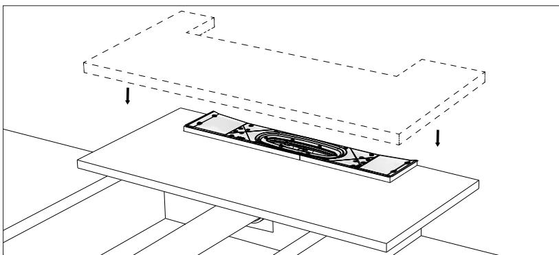
Lägg på en 22 mm spänplatta med öppning anpassad efter brunnenas storlek.
