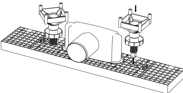
Tryck på Purusstöden på brunnen. Kontrollera att dom sitter ordentligt fast och justera till önskad höjd. Längderna 900-1200 har fyra hål för att fästa Purusstöden, använd hålen som är ytterst.
