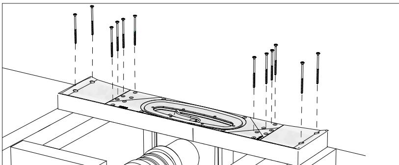
Montera brunnen direkt på träbjälklaget med träskruvar och mot rå vägg.
