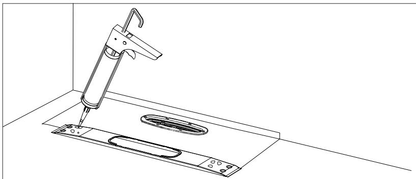
Punktlimma fast ramen på tätskiktet med montageglim alternativt fäst i klinkerfix. Du kan justera ramen i höjdled med hjälp av fix om så behövs.
