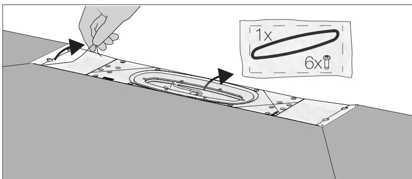
Ta bort skyddsfolien, lyft ur klämringen och plocka ut påsen som innehåller 1 st o-ring och 6 st skruvar.
