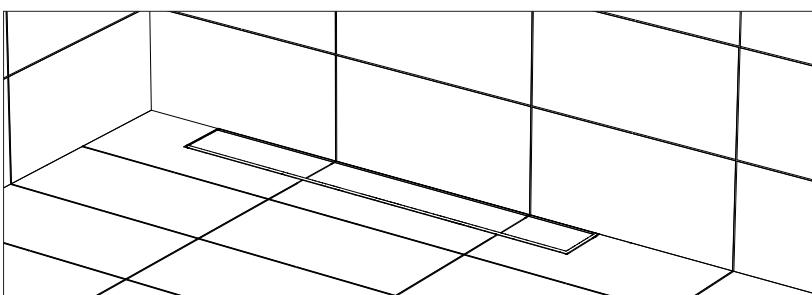
Vattenlåsets packning smörjs, hårsilen placeras i ramen och silen läggs på plats.
