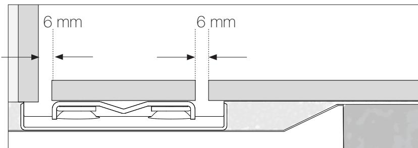
Klinkerplattan skall läggas ovanpå ramens kant, utrymmet under fylls med fix.
